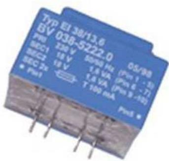
Transformateur moulé de marque ERA, type EI 38/13.6, primaire 230V, secondaire 2x18V, puissance 3.2 VA, dim. 40x36x28 mm.
