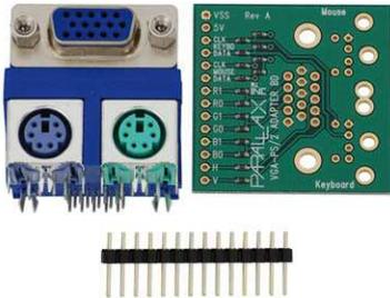
Module permettant de connecter un écran, une souris ou un clavier à toute platine de développement ou d'application à microcontrôleur de la série Propeller. A alimenter sous +5Vdc. Communication PS/2 synchrone série. Communication VGA : 2 bits DAC VGA signal.
