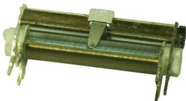
Potentiomètre bobiné,format résistance 1 KOhms.
