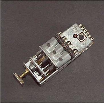
BOBINAGE NOYAU PLONGEUR.
