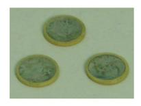
Condensateur chips, disque, 150 pf/500 Vdc.
