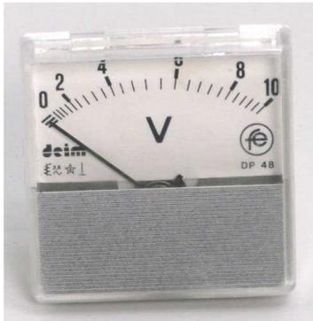
Voltmètre ferromagnétique 10 Vac.
