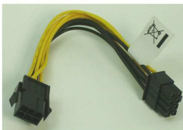
Adaptateur PCIe 6 broches >> ATX 12Vdc 8 broches.
