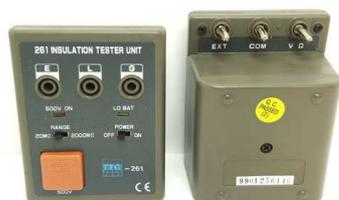
Module test insulation(prise de terre).
