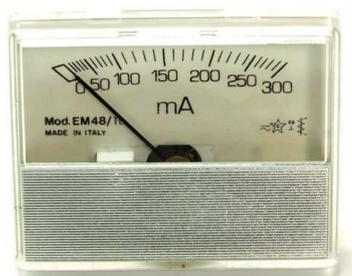
Ampèremètre 300mA ac/dc,ferromagnétique,classe 2,5.
