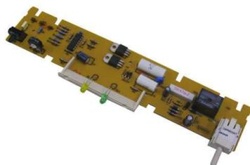
Module électronique commande thermostat,
