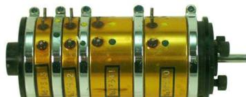
Potentiomètre bobiné, 2 x 100k + 1,69k + 380 Ohms.
