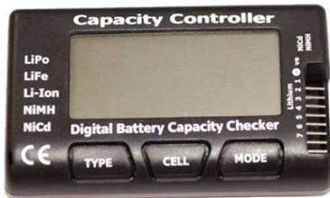
**Testeur de batteries LCD CellMeter-7 V2.**
