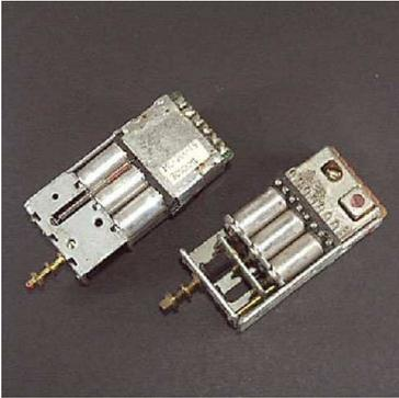
BOBINAGE NOYAU PLONGEUR.
