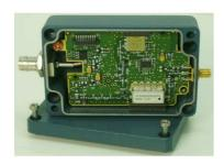
Boitier HF Philips, pour le médical. Connectique SMA femelle/BNC femelle. Equipé module:BP45R2400S200A.
